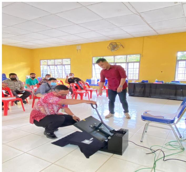
**Gambar 3.** Peserta melakukan praktek pengepresan kertas sublime pada kaos dengan mesin pressing
