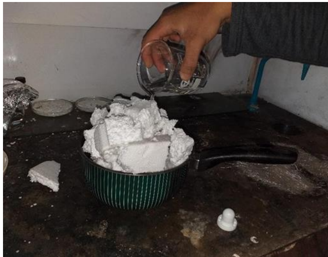
Gambar 3.5. Pelarutan Sampah Plastic Steroform (SPS) Dengan Pelarut Xilena.
