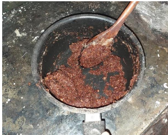
Gambar 3.8. Pengadukan Campuran Limbah Kayu Serbuk Gergajian (LKSG) Dalam Larutan Sampah Plastic Steroform (SPS) Dengan Pelarut Xilena.
