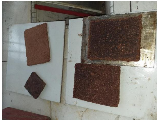
Gambar 3.11. Hasil Pencetakan Papan Partikel Basah Dengan Bahan Baku Campuran Limbah Kayu Serbuk Gergajian (LKSG), Sampah Plastic Steroform (SPS) Dan Pelarut Xilena.
