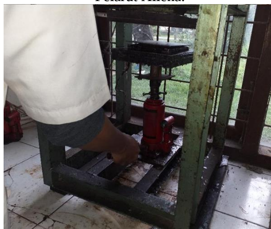
Gambar 3.9. Pengisian Cetakan (Ukuran 15 X 10 X 0,8 Cm 3 ) Dengan Bahan Baku Campuran Limbah Kayu Serbuk Gergajian (LKSG) Dalam Larutan Sampah Plastic Steroform (SPS) Dengan Pelarut Xilena.
