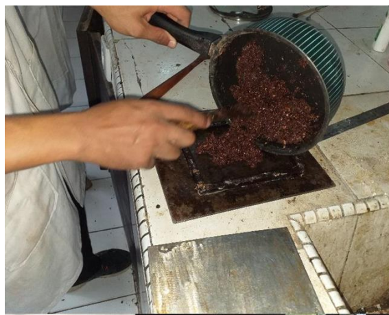
Gambar 3.9. Pengisian Cetakan (Ukuran 15 X 10 X 0,8 Cm 3 ) Dengan Bahan Baku Campuran Limbah Kayu Serbuk Gergajian (LKSG) Dalam Larutan Sampah Plastic Steroform (SPS) Dengan Pelarut Xilena.
