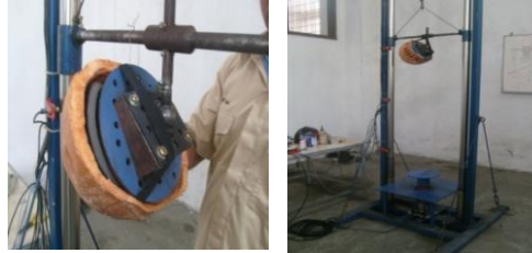
Gambar 3.1. Pemasangan helmet sepeda pada tes rig
