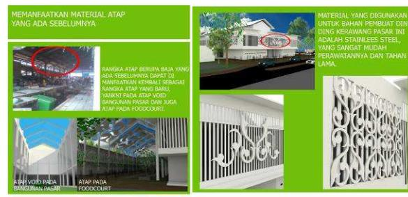
**Gambar 9. Pemanfaatan Rangka Atap Baja Pada Pasar Lama**
