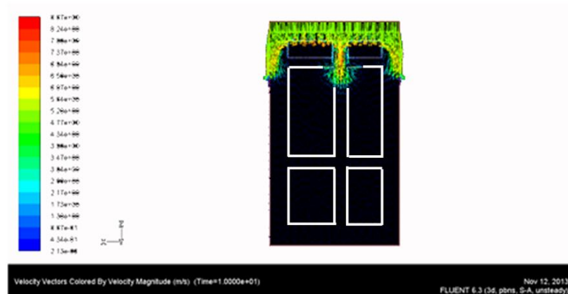
Gambar 7. Hasil Simulasi CFD Akibat Perubahan Jalan Lingkungan
