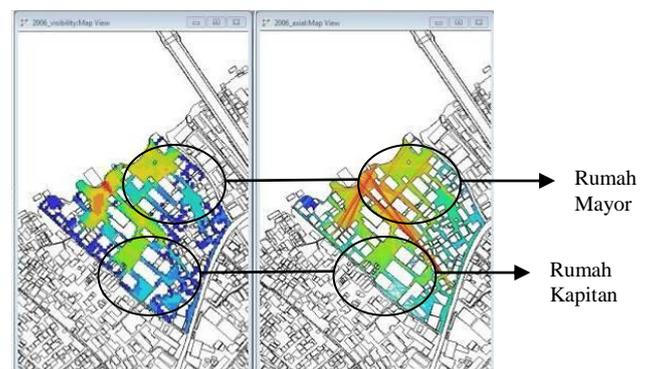
**Gambar 5.** Analisa *Visual graph* (kiri) dan Analisa *Axial map* (kanan) untuk Kondisi Tahun 2006
